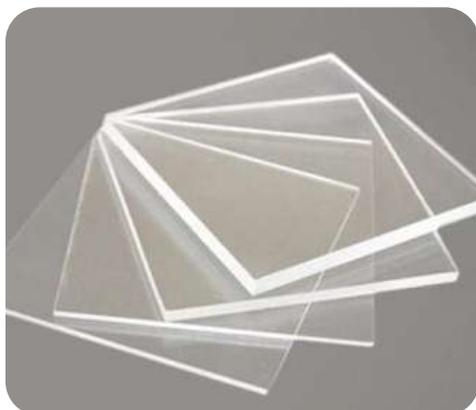
El acrílico es un polímero termoplástico transparente o pigmentado con una extensa gama de colores. Este se obtiene de la polimerización del monómero de metacrilato y se funde para ofrecerlo en láminas de medidas estándar.
