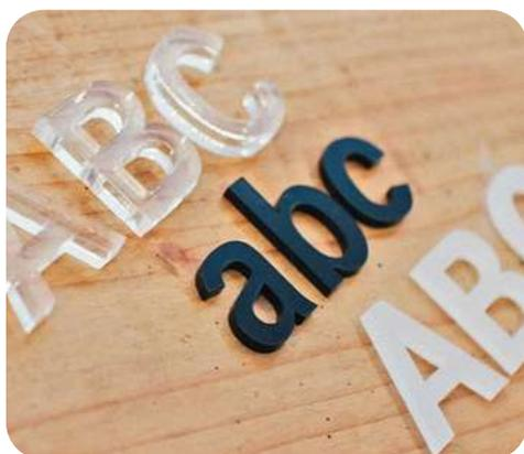
Cuando el acrílico extruido se corta con un láser, crea un borde de corte pulido con efecto flameado que es menos afilado en un lado. El proceso de producción del acrílico extruido es más barato y, por lo tanto, su precio es más bajo al producirse en serie.
